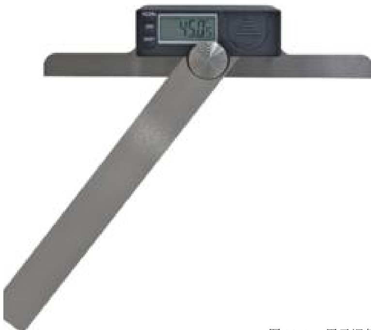
图 11-2: 用于调整双摇臂悬架的角度测量仪
